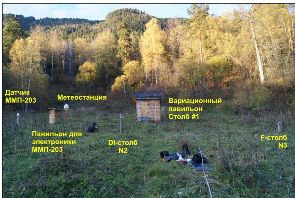
Рис.6. Общий вид аппаратуры и строений на магнитной станции "Байгазан" в октябре 2012 г. На переднем плане видна регистрирующая аппаратура POS-1 и другое оборудование (отнесенное от датчиков).
