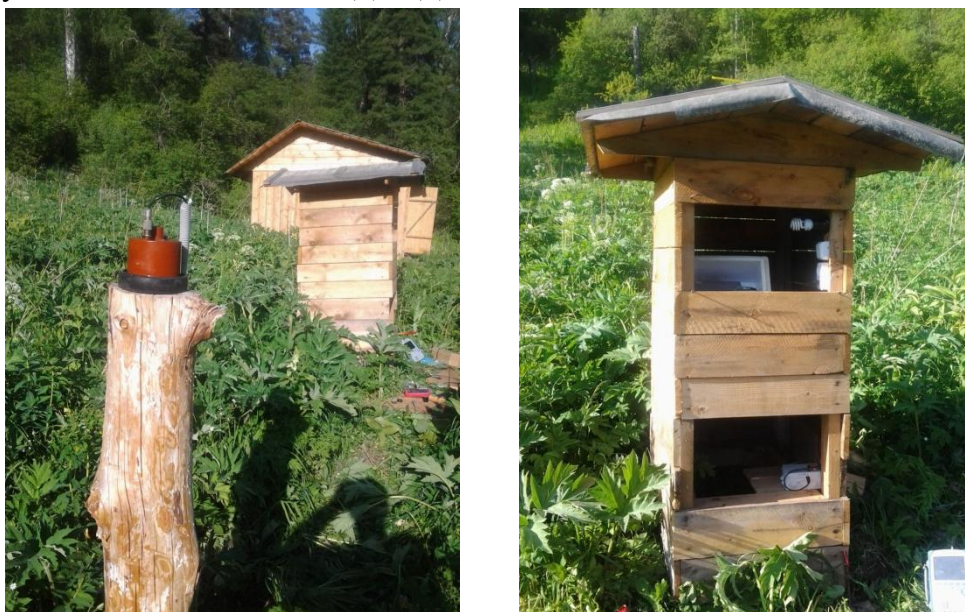
Рис.5. Павильон для регистратора и МИП протонного магнитометра ММП-203 и датчик ММП-203 на отдельном выносном столбе.
