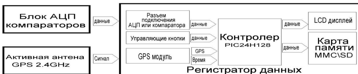
Рис. 1. Блок схема регистратора данных
